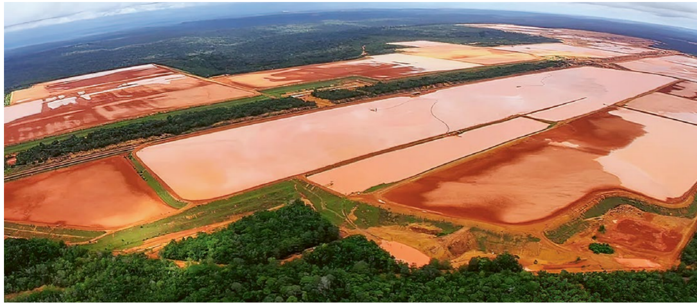
Bassins de rétention de la Mineração Rio do Norte (MRN) à Oriximiná, au Brésil, 2016. Les bassins servent à stocker les résidus provenant de l'extraction de la bauxite.
