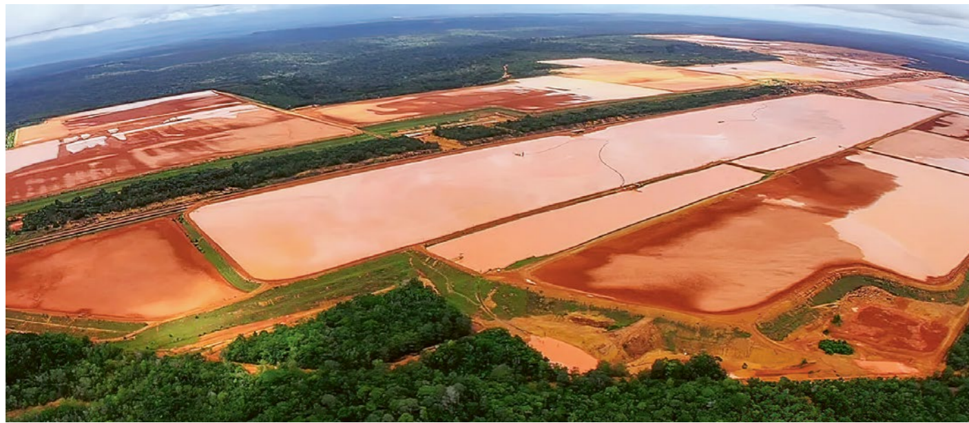
Rückhaltebecken der Mineração Rio do Norte (MRN) in Oriximiná, Brasilien, 2016. In den Becken werden Rückstände aus der Bauxit-Förderung gelagert.
